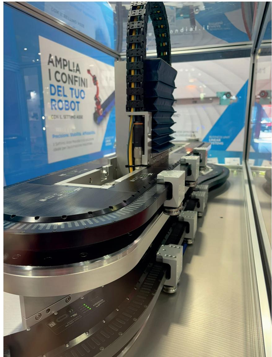
sistema circolare vengono perfettamente allineate tra loro permettendo così il passaggio del carrello in modo preciso e veloce da un circuito all'altro.
